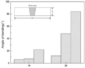
Fig. 5. Angle of bending (1#) FCAW, (2#) U-FCAW.[3]
